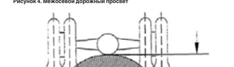
Рисунок 5. Дорожный просвет под одной осью
